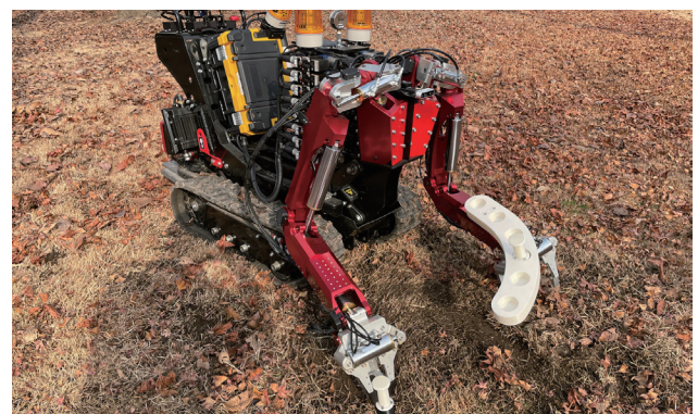
김명수 선임연구원 연구팀은 한국원자력연구원과 함께 협업해 시료 채취를 할 수 있는 로봇팔을 제작했다.
